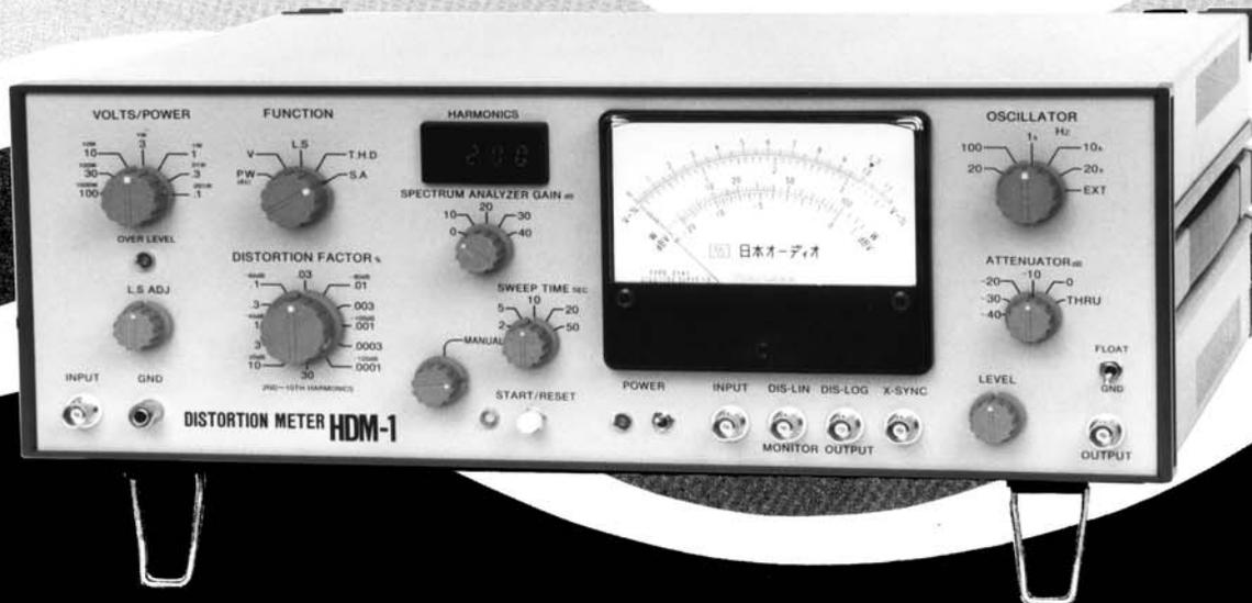
高性能アンプ、高性能部品等の測定のために開発された発振器内蔵の「超低ひずみ率計」です。更に高度な要求に応じて、各高調波を個別に取出す「掃引型周波数分析機」が組み込まれていますから、ペンレコーダ、ストレージオシロ等を併用して、ひずみ成分のスペクトラムを簡単に書かせることができます。
